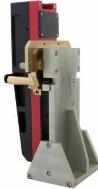
BP-ROD: bloco de calibração montagem na roda
